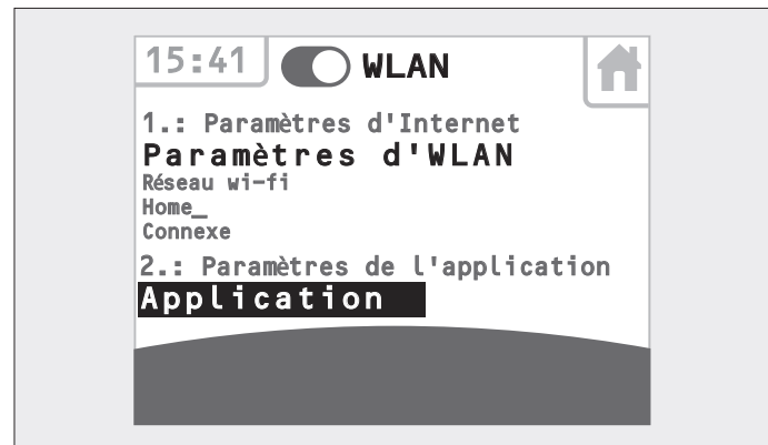
Fig. 3.34 Panneau de commande tactile – Accès au Wi-fi activé
