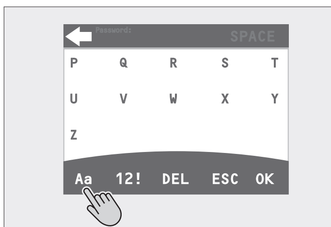
Fig. 3.37 Panneau de commande tactile – Sélection d'autres lettres et de l'écriture en majuscules ou en minuscules
