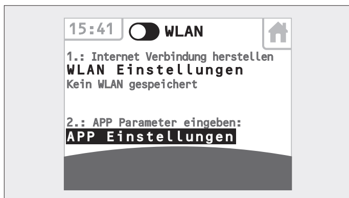
Abb. 3.42 Auf WLAN-Einstellungen wechseln und Netzwerk festlegen.
