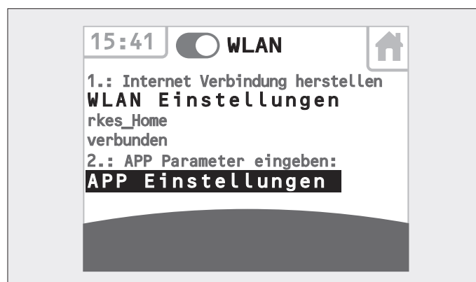
Abb. 3.34 Touch-Bedienfeld – WLAN Empfang eingeschaltet
