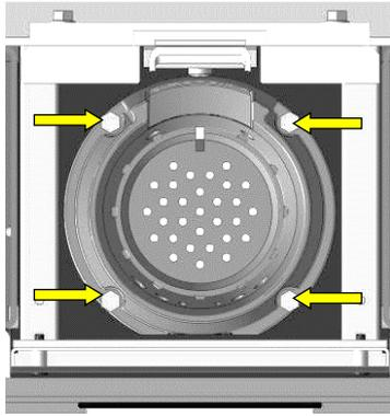
Abb. 54: Verschraubungen Brennerkopf
