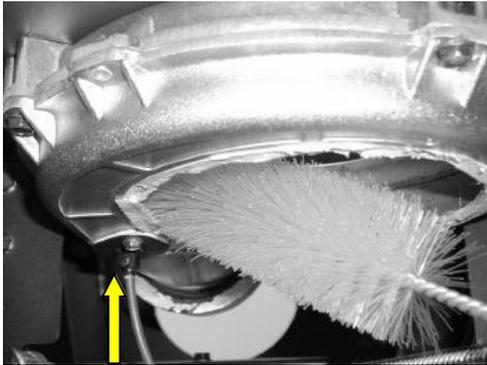
Abb. 63: Reinigung Gebläsegehäuse
