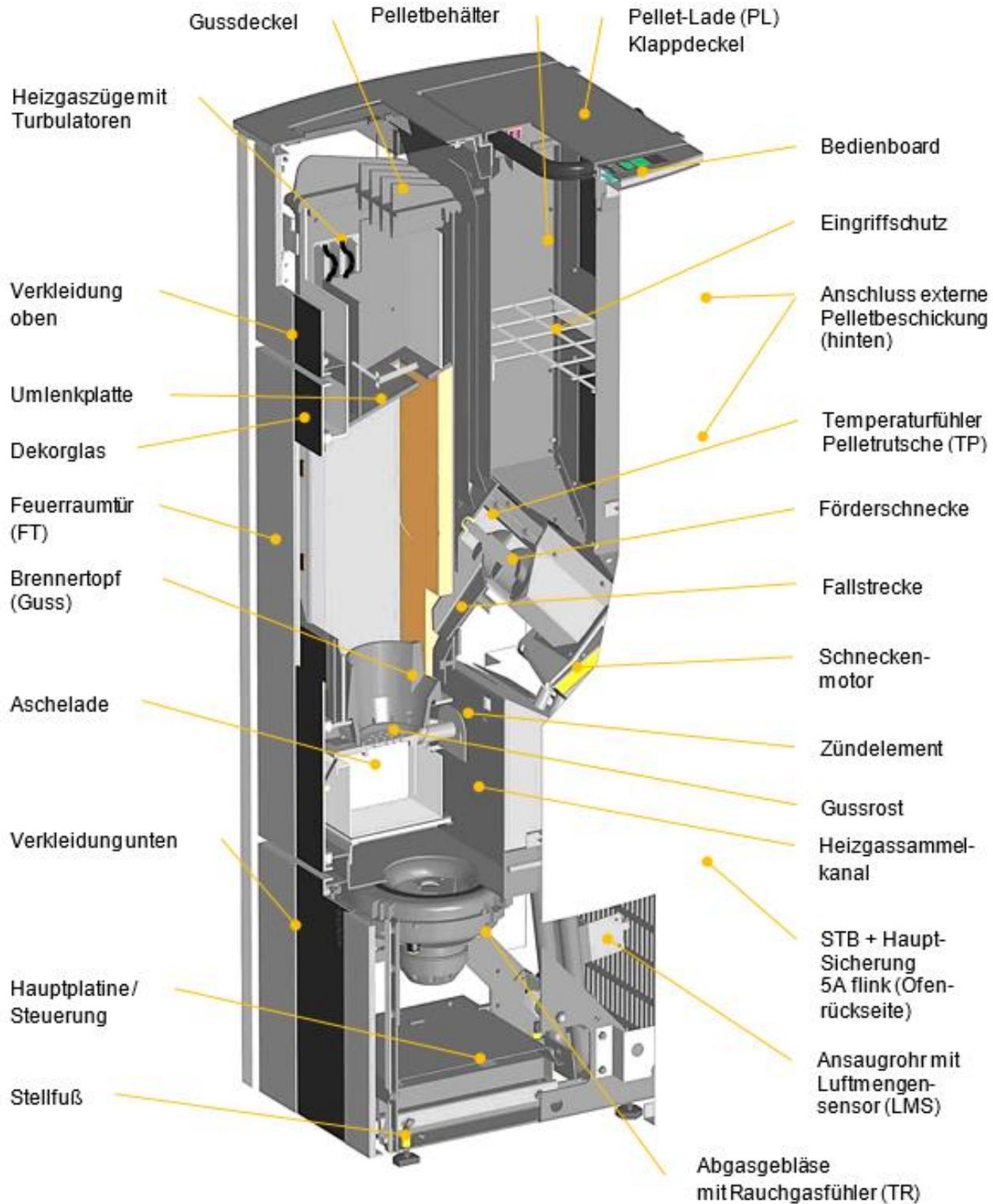
Abb. 37: Funktionsschnitt
