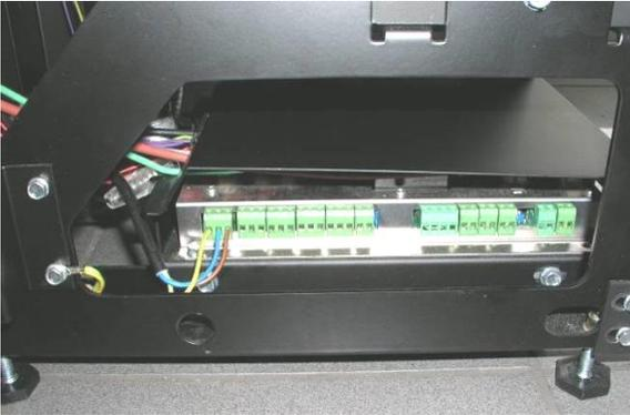
Abb. 18: Seitliche Anschlüsse Hauptplatine
