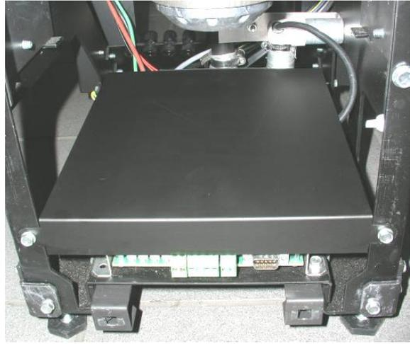
Abb. 19: Vordere Anschlüsse Hauptplatine
