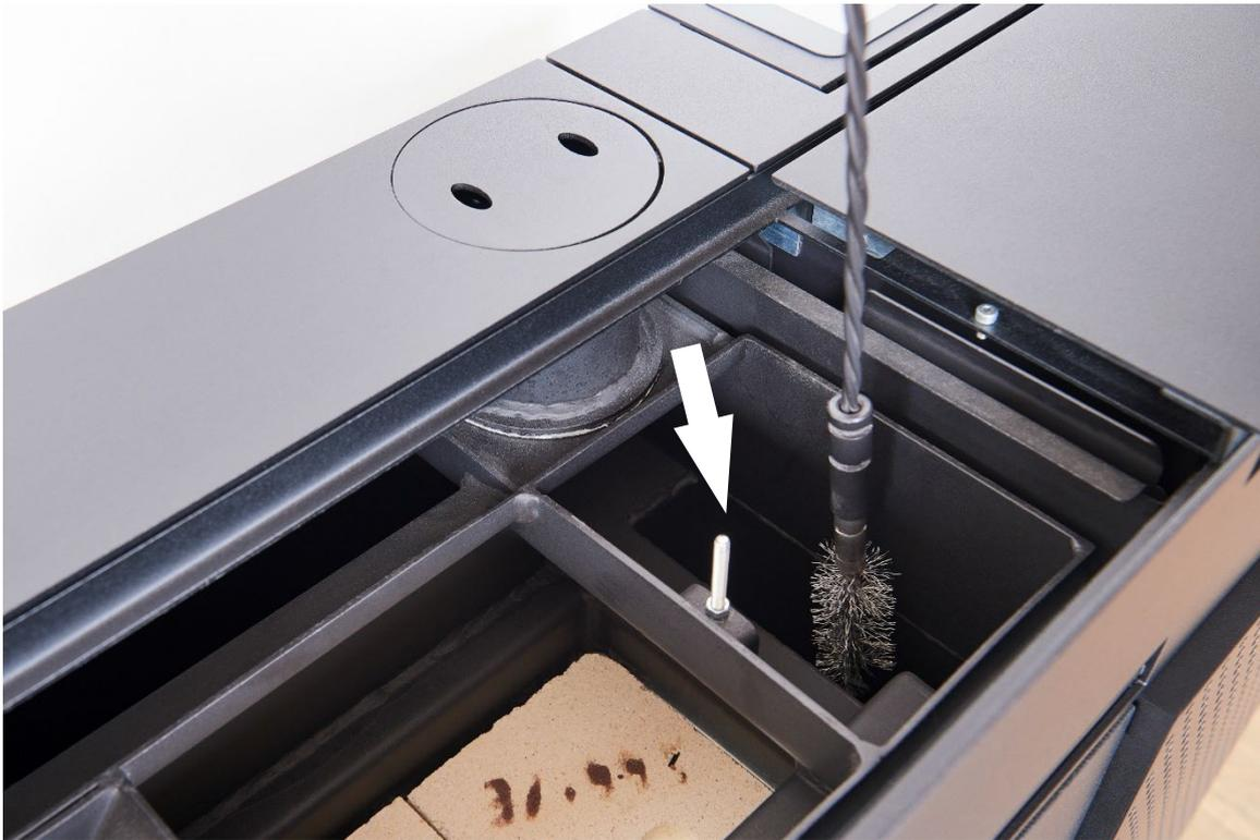
*Rauchgaszüge von oben, diese sind zu reinigen*
