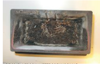
BEISPIEL VERSCHMUTZTE BRENNSCHALE
