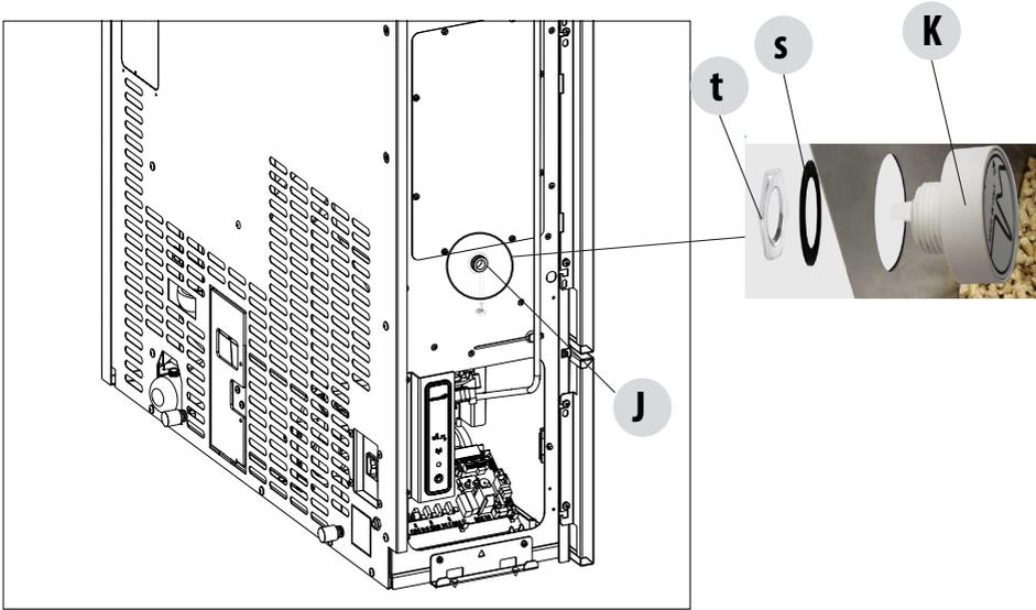
Der Pellet-Sensor ist ein Anzeiger für die Brennstoffreserve, der dazu dient, dem Benutzer zu melden, dass die Pellets fast verbraucht sind.
